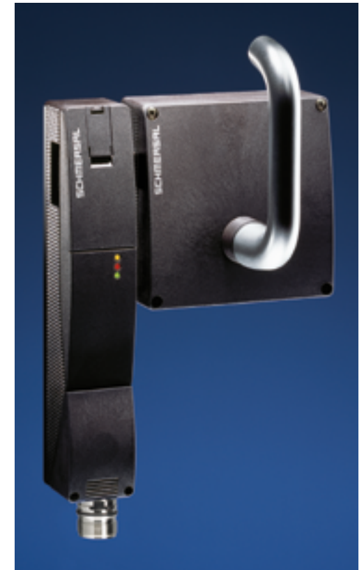
Abb. 1: Neue Lieferausführung der Sicherheits-Zuhaltung AZM 200-D mit zwei wahlweise ansteuerbaren Freigabeebenen: 1 × als Verriegelungseinrichtung mit Zuhaltung (PL „d“, SK 3, SIL 2); 1 × als Verriegelungseinrichtung ohne Zuhaltung (PL „e“, SK 4, SIL 3)
