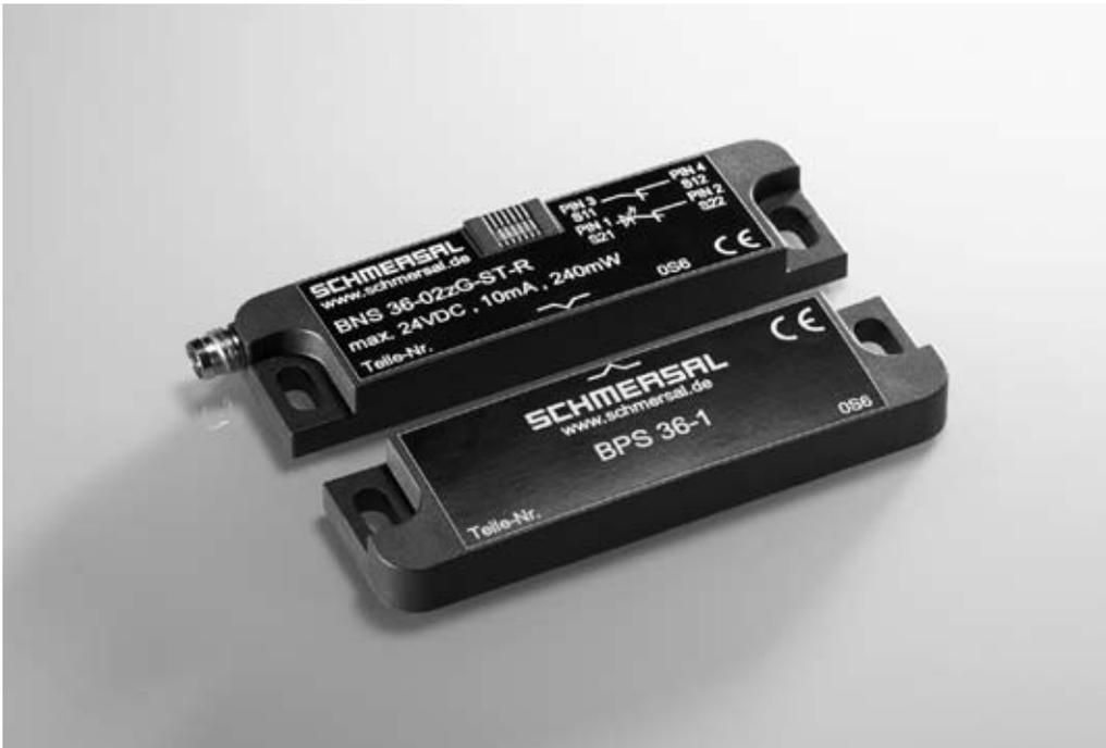
Mit einer Breite von 25 mm und einer Länge von 88 mm bei 13 mm Höhe sind die neuen Sensoren so kompakt, dass man sie auch an sehr kleinen Schutztüren und unter ungünstigen Bedingungen einfach in die Umgebungsstruktur integrieren kann. Der codierte Betätigungsmagnet minimiert das Risiko der Manipulation; auch für den um 90° versetzten Anbau steht eine Betätigerversion zur Verfügung. Die exakte Montageposition von Sensor und Betätiger kann über Langlöcher leicht angepasst werden
